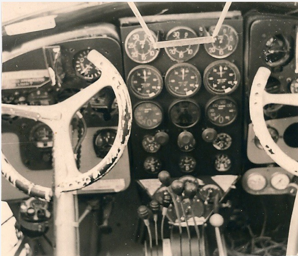
L'interno della cabina di pilotaggio: si notano le cloche rotte dall'impatto dell'atterraggio; le macchie scure sono sangue secco dei piloti. Ce n'era anche sui vetri della cabina di pilotaggio.
